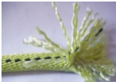
Paraloc – Seilmantel und Kern sind miteinander durch Zwischenfasern verbunden. Durch diese neuartige, patentierte Technologie ergeben sich herausragende Eigenschaften
